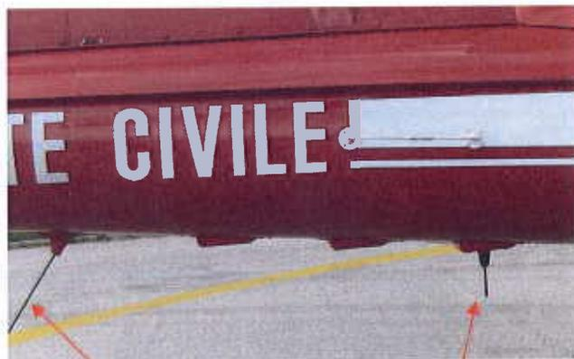
Antenne bande 85 MHz et Antenne bande 400 MHz
