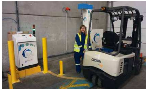
Figure 3: station de remplissage de chariot élévateur à hydrogène
