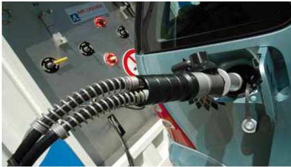
Figure 2: remplissage d'une voiture H 2
