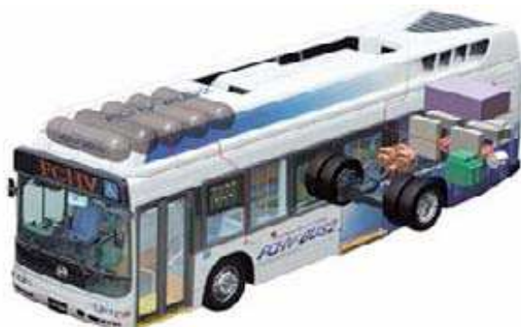
Figure 1 : Bus hydrogène – 25 à 40kg d'H 2
